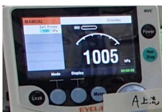
図2 下流側ニードルバルブ操作時の捕集カラム1段目付近圧力
