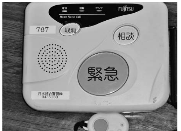
家の中に設置した緊急通報端末装置
