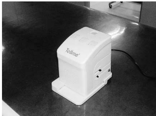
音声コードによる文書読み上げ装置 (中部健康福祉センターにて)
