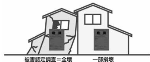
被災建築物の出入口などの認識しやすい場所に貼る判定ステッカー
